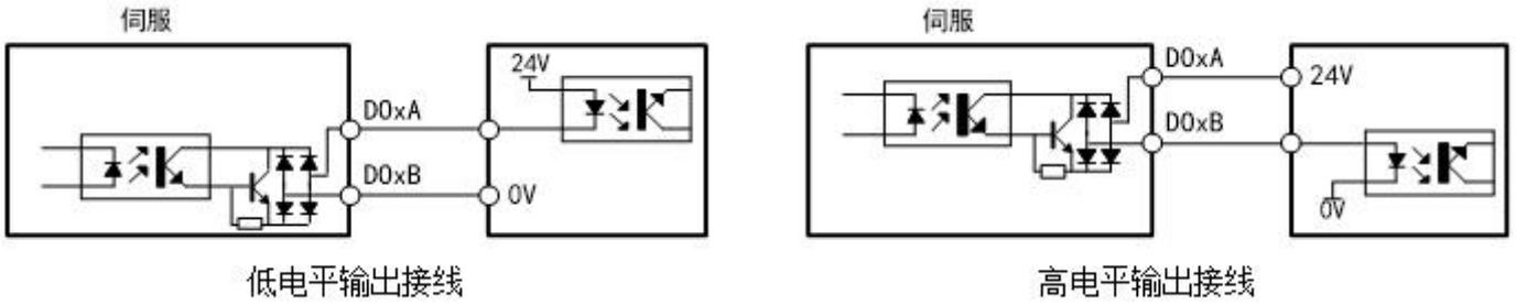
◆ D0 输出接线 (连接继电器)
