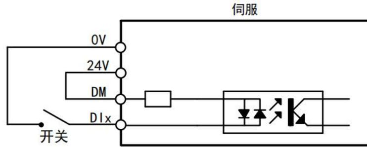
4.4.2 高速脉冲输入电路
