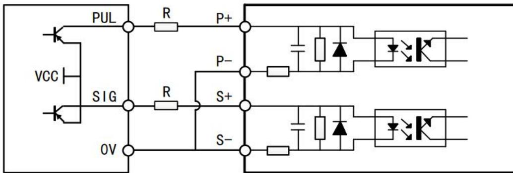
注：1) C630S-40/75：使用外置电阻接线时，当信号电压  $VCC=24V$  时， $R=2.4\text{ K}\Omega$ ；当信号电压  $VCC=12V$  时， $R=1.5\text{ K}\Omega$ ；当信号电压  $VCC=5V$  时， $R=0\ \Omega$ 。
