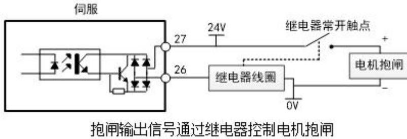
抱闸输出信号通过继电器控制电机抱闸
