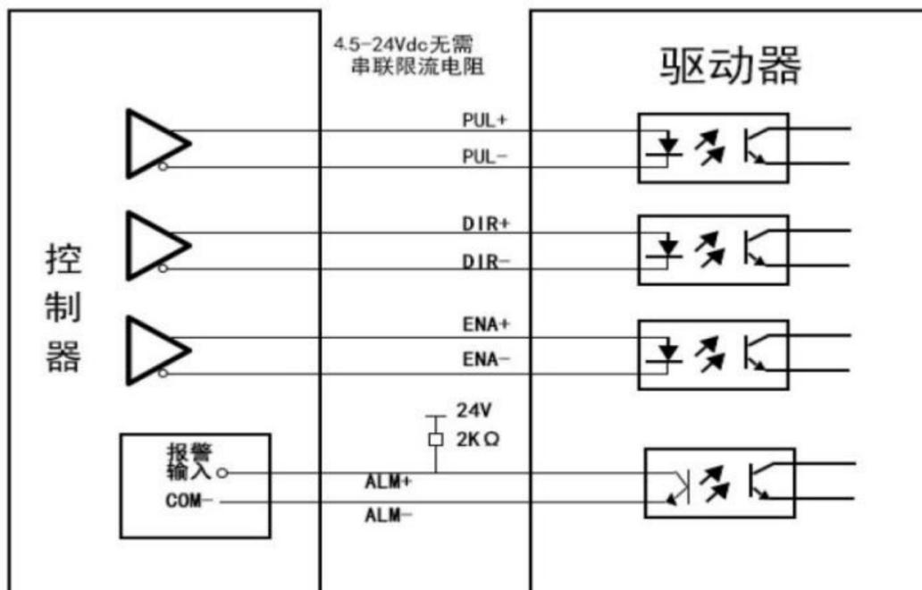
差分方式控制信号接口接线图
