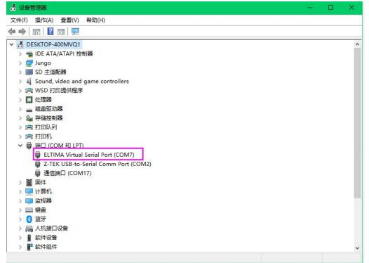
2、打开PLC编程软件(GX developer 8.52E/8.86Q或者GX works2)并打开需要下载的工程,选择对应的虚拟串口如com7,如图:
