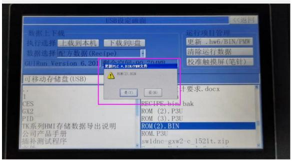
7、待进度条更新完毕,触摸屏会自动重启,重启完,即成功把 PLC 程序下载到触 摸屏 PLC一体机中,如图:
