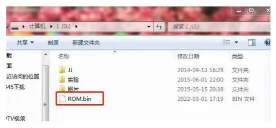
5、将U盘插在一体机的USB口会跳转到USB设定画面,点击"更新\*.HW6/BIN/PMW文件",输入当前触摸屏工程的超级密码(默认为 12345678),如图:
