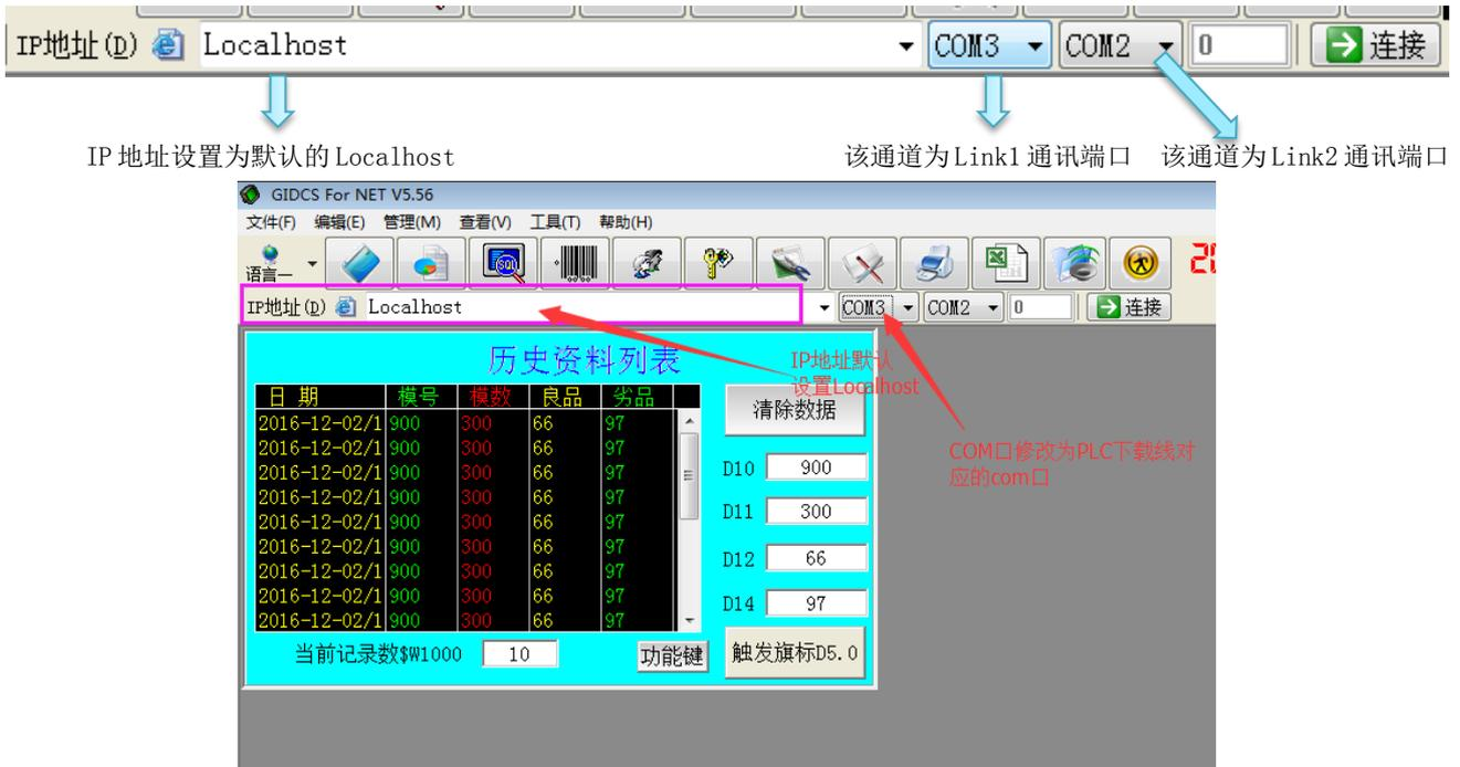
使用 PLC 下载线将电脑和 PLC 连接，PLC 下载线对应的 COM 口为 COM3:
