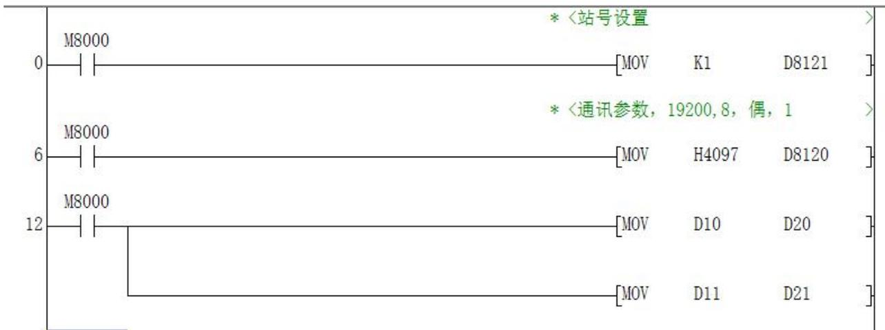
程序解释: 将主站 PLC 中寄存器 D31、D32 的 2 个数据写入从站为 1 的 PLC 中, 保存在从站 PLC 的寄存器 D10、D11。
