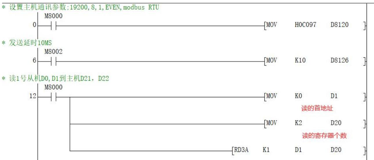
程序解释: D20 保存读取的寄存器个数, 此处表示读 2 个数据。程序表示读取从站为 1 的 PLC 中寄存器 D0-D1 共 2 个数据, 保存在主站 PLC 的寄存器 D21-D22 中。
