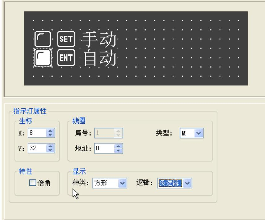
以同样方法设置手动按钮，手动状态指示灯。指示灯的地址仍然对应 M0，显示属性取负逻辑。指定按钮为“ENT”键，按钮功能为置 M0 继电器 OFF。
