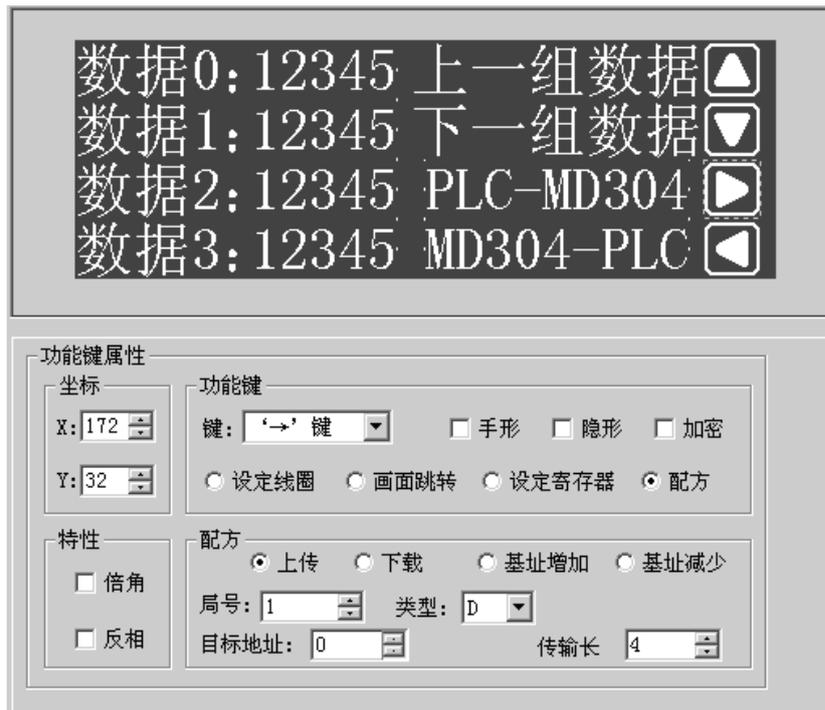
地址类型选“D”，目标地址选“0”，传输长选“4”。这样把画面下载到显示器里，运行后点击
