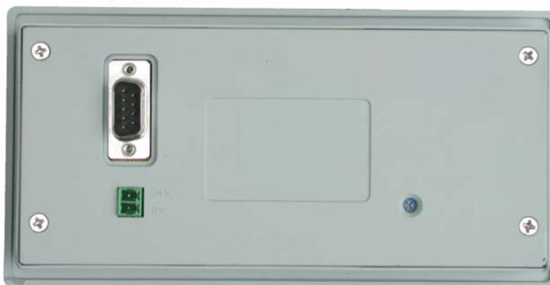
产品背面为外接 DC 电源端子和 9 针 D 型公座的通讯端口,RS232、RS485 和 RS422 通讯端口都是置于 9 针 D 型插座中,下载画面数据时,使用通讯电缆 HW-PLC 将 HW-40 的 9 芯通讯口和个人计算机的 9 芯通讯口连接起来,和 PLC 通讯时,根据 PLC 机型确定通讯口连接方式(在组态软件中设定)。
