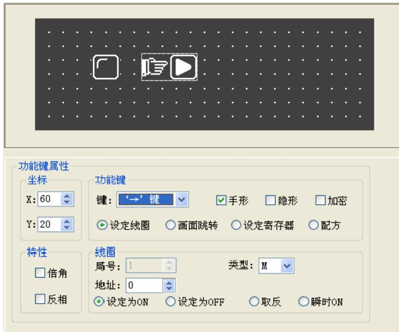
在功能栏中，选择“SET”键作为自动模式设定按钮。将继电器定义号设定为 M0，选择动作模式设定为 ON。为了简明显示，取消手形显示。
