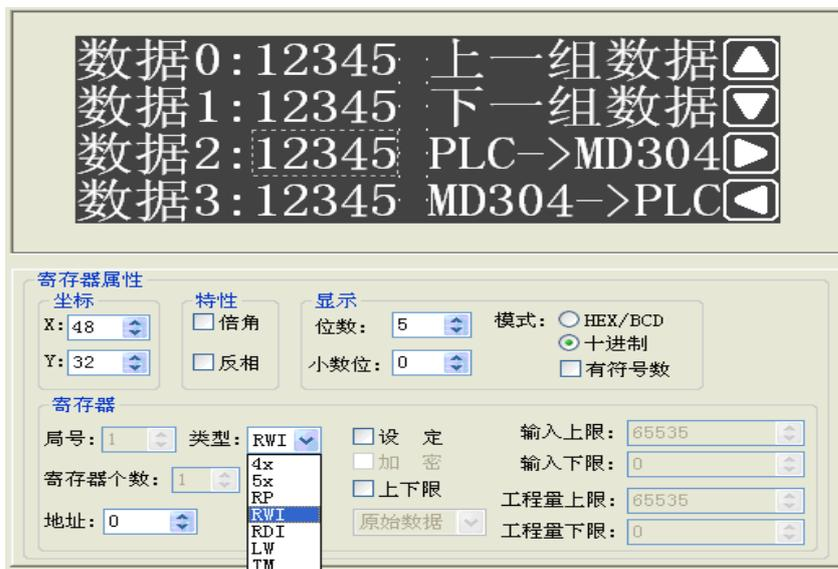
地址类型选“D”，目标地址选“0”，传输长选“4”。这样把画面下载到显示器里，运行后点击
